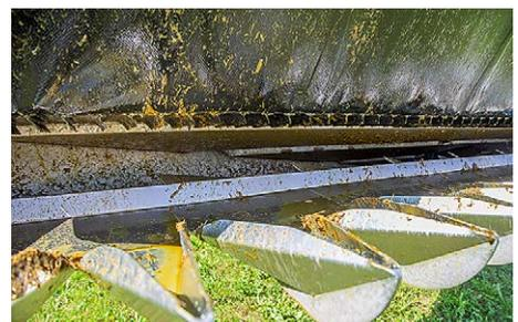
Über Edelstahlbahnen wird die Gülle in die Schleppkufen geleitet. Das Gummituch ist hier aufgeklappt. Es ist mit zusätzlichen Stegen versehen, die den Güllstrom bremsen und leiten sollen. Denn während der Arbeit spritzt die Gülle regelrecht durch den Edelstahlkasten.
