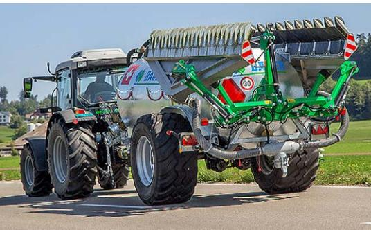
Die Verteiler klappen kompakt. Die Nachrüstung ist mit Weiste-Dreieck und zusätzlicher Strebe oben am Fass einfach möglich.
