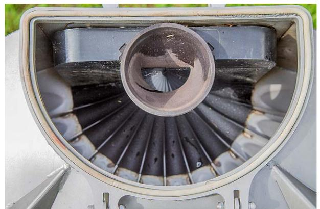
Die Gülle schießt von oben auf eine „Rutsche“, der Güllestrahl wird zerrissen und aufgeteilt. Rechts: Ein Blick von oben in den Verteiler. Die Kunststoffbahnen gehen in Edelstahlbahnen über. Die gesamte Düse ist austauschbar.
