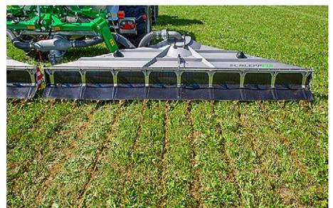
Die Güllestreifen sind breiter und weniger exakt geformt als bei einem Schleppschuhverteiler mit Federstahlkufen. Unbedingt empfehlen wir 15 cm Kufenabstand, wie hier auf der linken Verteilerseite.
